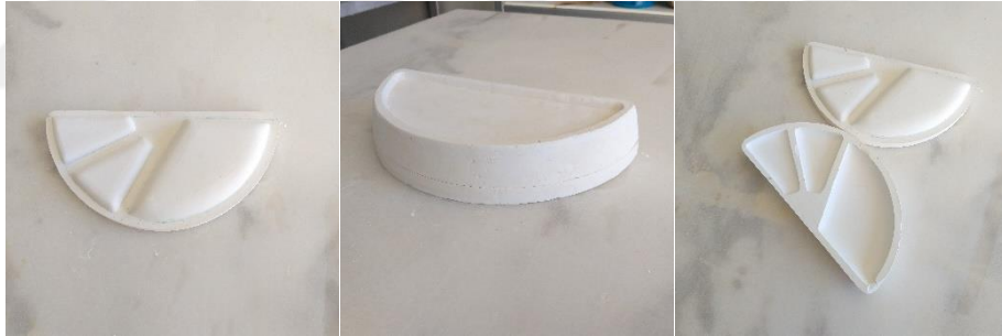
Resim 66 Salata ve sos tabağı model oluşturma aşması
