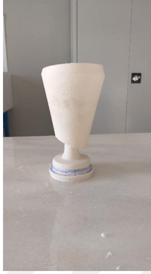
Resim 71 Kadehin alçı model oluřturma ařaması
